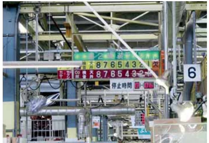
Figur 5. Produktion av ett nytt Toyota Home. Till vänster ses de röda och gula Andon snörena och till höger ses en s.k. Andon tavla som i realtid visar linans status.
